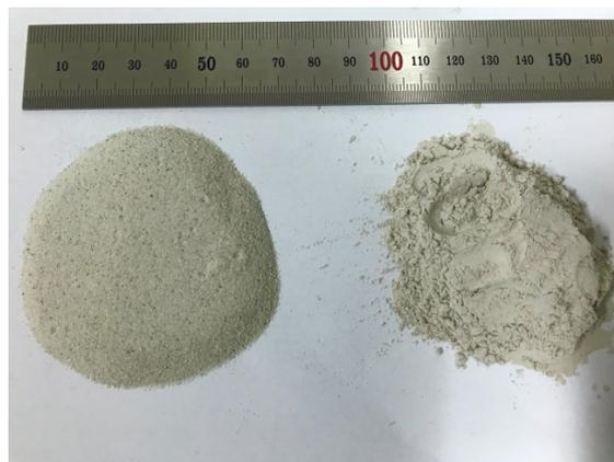
Рис. 1. Керамический песок (слева) и керамический порошок (справа).
