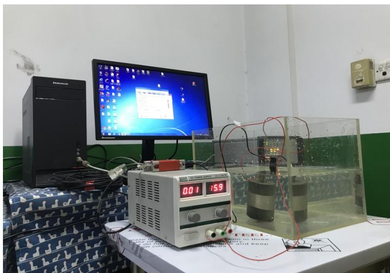
Рис. 4. Внешний вид установки по испытанию на ускоренную коррозию.
