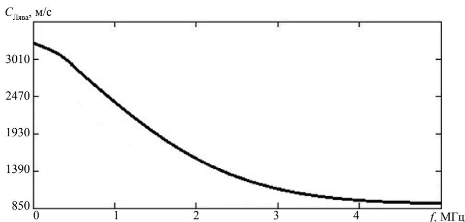
Рис. 3. Графическая зависимость скорости волны Лява от частоты ультразвука при шероховатости  $R_z = 1$  мкм.
