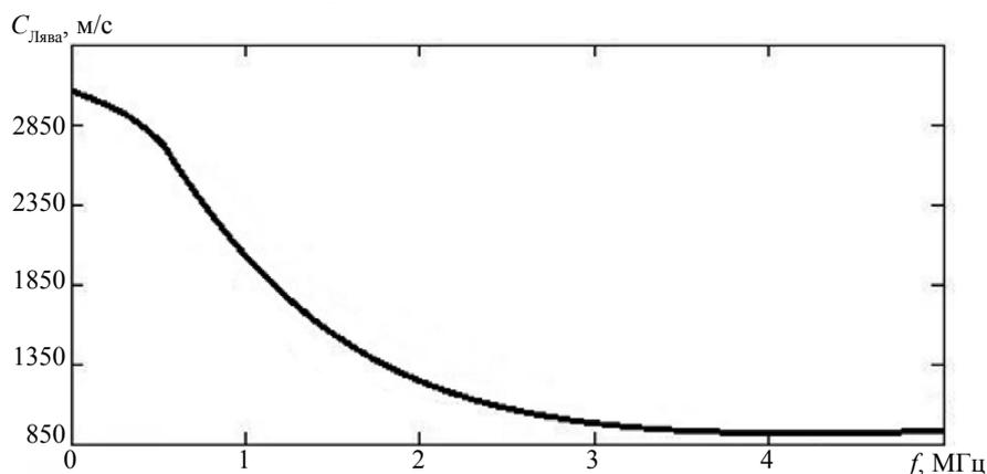
Рис. 4. Графическая зависимость скорости волны Лява от частоты ультразвука при шероховатости  $R_z = 10$  мкм.
