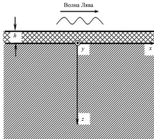
Рис. 1. Модель структуры «твердая среда—упругое полупространство».
