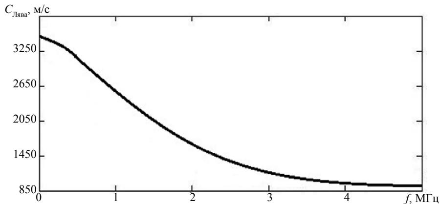
Рис. 2. Графическая зависимость скорости волны Лява от частоты ультразвука.
