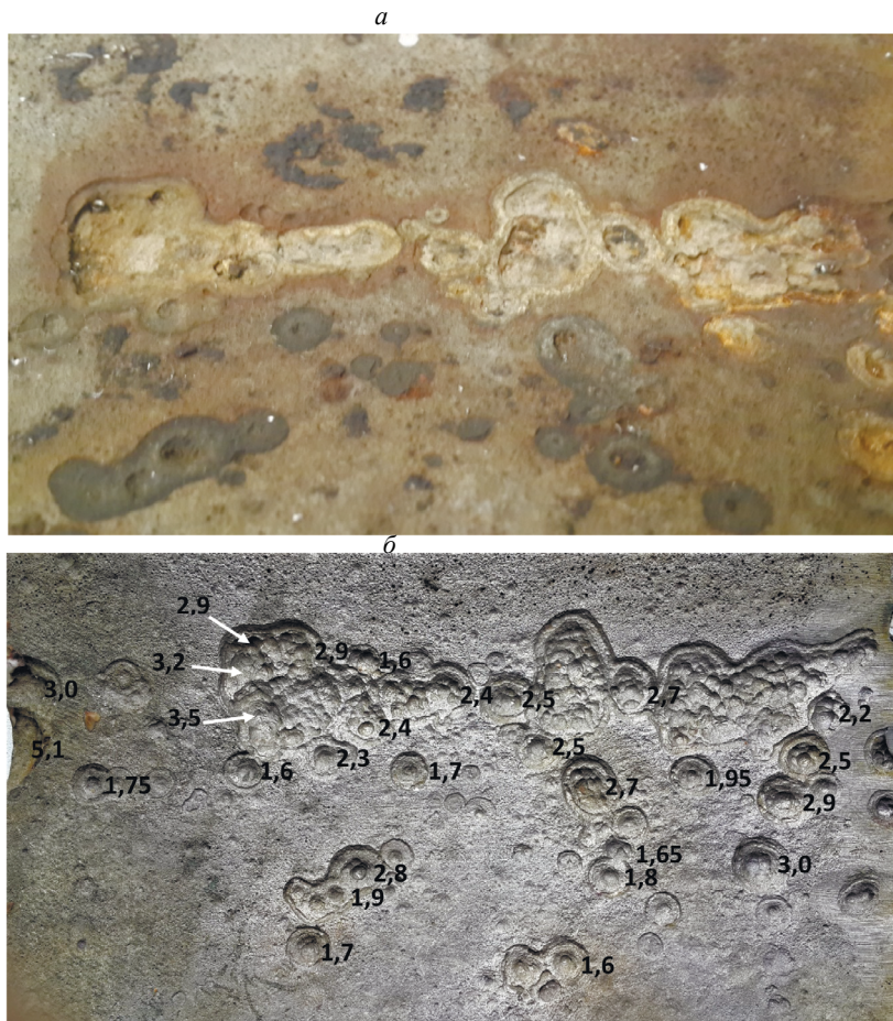
Рис. 6. Внешний вид сегмента № 2 после травления (глубина дефектов указана в мм).
