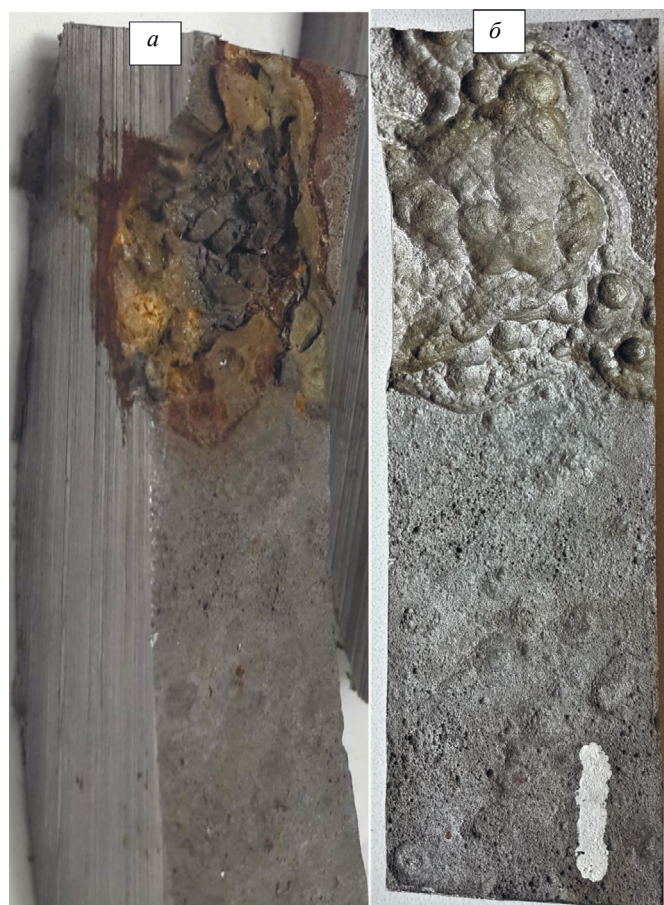
Рис. 5. Внешний вид вырезанного сегмента № 1 на патрубке 1 с коррозионной аномалией: a — после первого травления; б — после второго травления и полного удаления продуктов.
