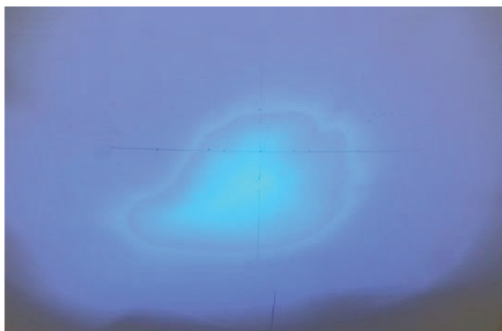
Рис. 6. Вид фокусного пятна от УФ-облучателя КД-33Л.
