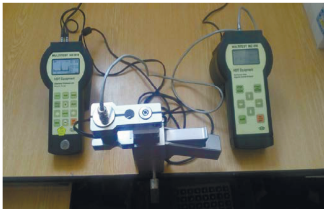
Рис. 1. Внешний вид системы с конфигурацией — тест-клещи DK100, MULTITEST-MC010 и MULTITEST-CD010.
