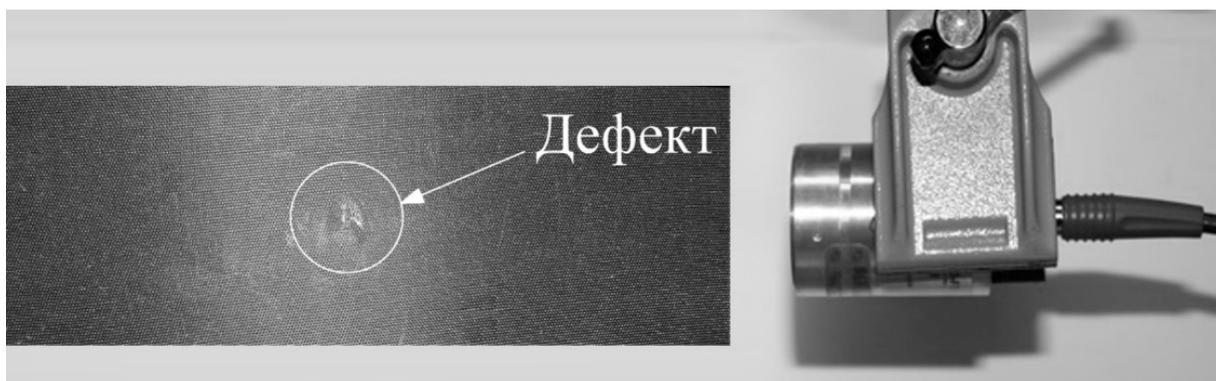
Рис. 3. Акустическая стимуляция углепластикового композита с использованием воздушно-связанной системы на основе ПЭП (расстояние от излучателя до дефекта 10 мм, размеры образца 270×40×1,2 мм).
