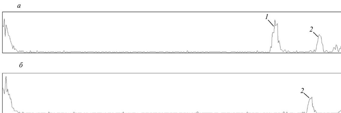
Рис. 4. Характерные А-сканы для рассеяния продольной волны на верхнем (а) и нижнем (б) ребрах паза: а — головная волна 16,22 мкс (1),  $L-L$  18,84 мкс (2); б —  $L-L$  18,36 мкс (2).
