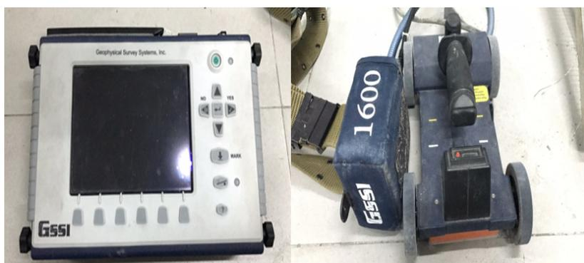
Рис. 2. ГРЛ-приемник и ГРЛ-антенна.
