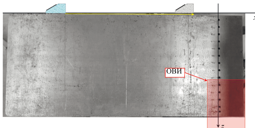
Рис. 10. Фотография образца толщиной 210 мм из стали 40 и схематическое изображение области сканирования.
