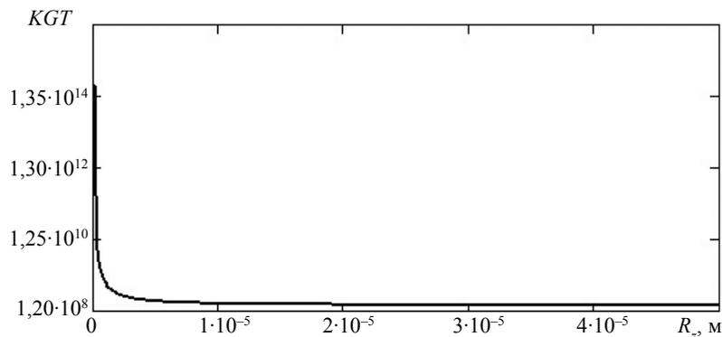
Рис. 3. Зависимость тангенциального коэффициента жесткости от величины шероховатости.
