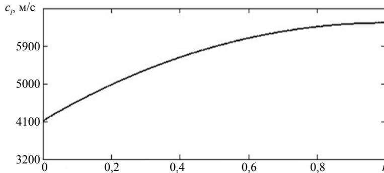
Рис. 4. Зависимость скорости продольной волны от относительной толщины слоя при распространении параллельно слоям.
