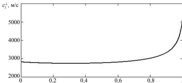
Рис. 5. Зависимость скорости продольной волны от относительной толщины слоя при распространении перпендикулярно слоям.
