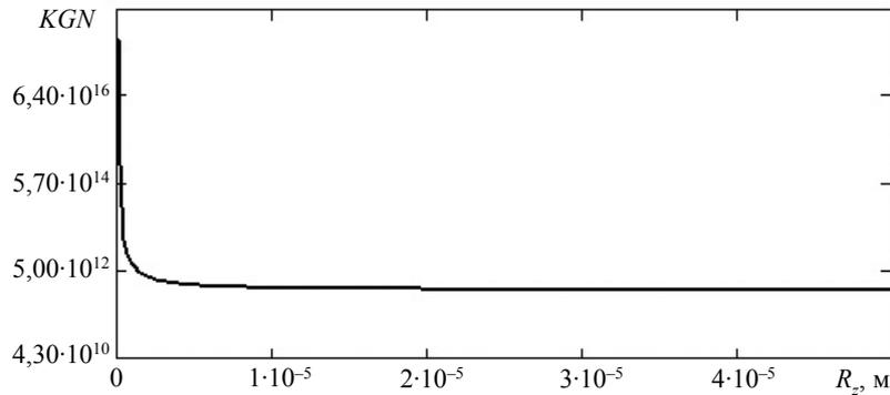
Рис. 2. Зависимость нормального коэффициента жесткости от величины шероховатости.
