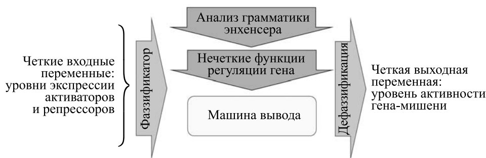
Рис. 3. Диаграмма системы нечеткой логики в приложении к проблеме моделирования экспрессии генного регуляторного элемента (энхансера). Машина вывода (inference engine) использует нечеткие функции генной регуляции, которые формулируются на основе анализа грамматики энхансера (см. текст).
