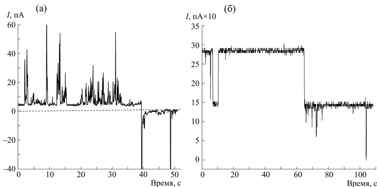
**Рис. 3.** Электрофизические характеристики пор, образованных хеликазой SsoHel308. (а) – Флуктуации тока при добавлении 38.52 мкг/мл хеликазы (out), напряжение  $\pm 100$  мВ. (б) – Флуктуации тока в присутствии хеликазы SsoHel308. Концентрация (out) 8.12 мкг/мл, напряжение  $+100$  мВ, раствор – 1 М KCl.
