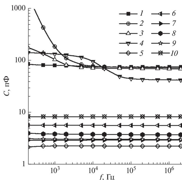
Рис. 2. Зависимость емкости измерительного конденсатора с образцами от частоты (1 – глицерин; 2 – глицерин + SPAN80; 3 – глицерин (ИИЭ); 4 – глицерин + SPAN80 (ИИЭ); 5 – СМ; 6 – СМ + АУ; 7 – ВМ; 8 – ВМ + АУ; 9 – ВМ + SPAN80, 10 – пустой конденсатор).
