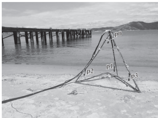
Рис. 2. Металлическая пирамида с установленными 4-мя измерительными гидрофонами.
