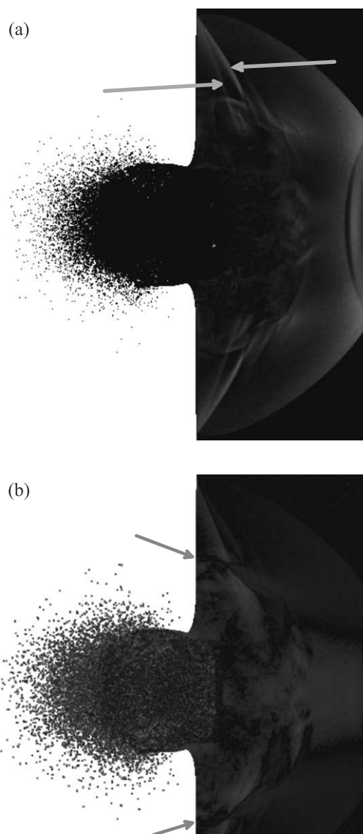
Рис. 8. (Цветной онлайн) t = 25.2 пс. (а) – Поле эквивалентного напряжения “по Мизесу”. Голубыми стрелками отмечены клиновидные волны разрежения, бегущие в объем, за точкой \Pi^* соприкосновения падающей УВ со свободной границей. (б) – Поле x -компоненты скорости: в области красного цвета вещество движется направо, в области зеленого – налево. Красными стрелками показаны поверхностные волны Рэлея, формирующиеся внутри сложной распространяющейся волновой структуры
