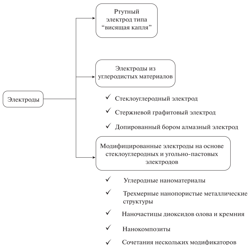
Рис. 3. Классификация электродов, применяемых для определения флаванонов.
